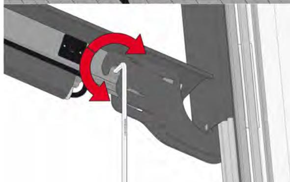
5. Schieben Sie auf beiden Seiten die Putzriegel des oberen Flügelrahmens aus den Schließböcken des Blendrahmens, um den Flügel zu entsichern.
