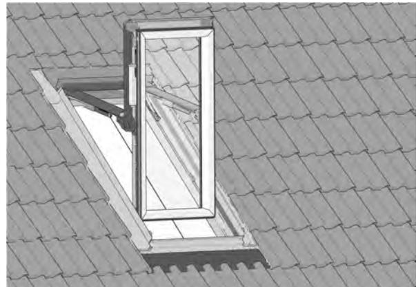
3. Schieben Sie auf beiden Seiten die Putzriegel des oberen Flügelrahmens in die Schließböcke des Blendrahmens, um den Flügel zu sichern.
