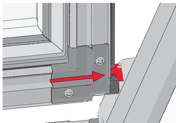
4. Drehen Sie mithilfe eines passenden Sechskantschlüssels die Schrauben an den gezeigten Stellen in eine Richtung.
