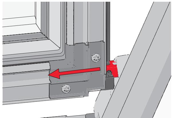
6. Drehen Sie den oberen Flügelrahmen zurück in die Ausgangsposition.
