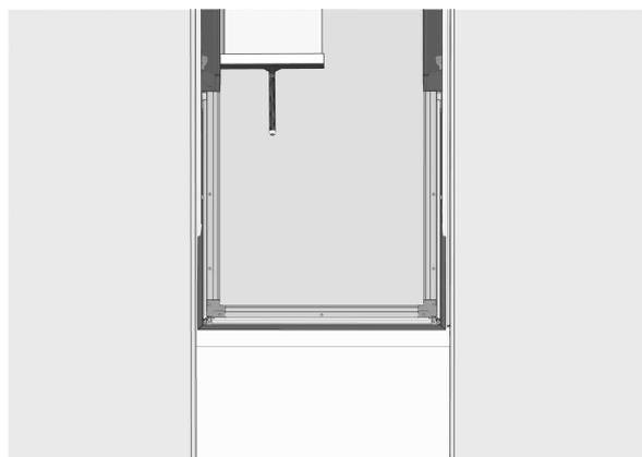
5. Schieben Sie auf beiden Seiten die Putzriegel des oberen Flügelrahmens aus den Schließböcken des Blendrahmens, um den Flügel zu entsichern.
