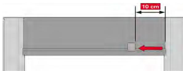
6. Schieben Sie das obere Eindeckrahmenblech unter die obere Dichtung des Wohndachfensters und über die seitlichen Eindeckrahmenbleche.
