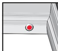
Der Flügelrahmen entriegelt und öffnet sich etwas.
